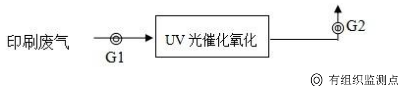
图 4-1 印刷废气处理流程
