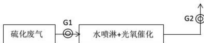
图 4-4 本项目硫化废气处理流程及监测点位图
