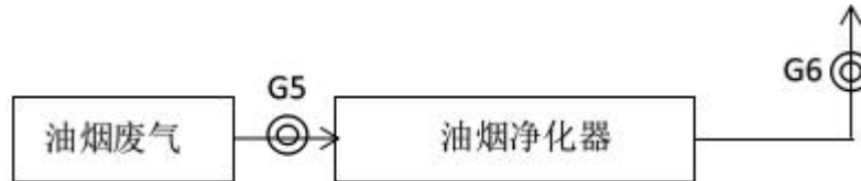
图 4-6 本项目油烟废气处理流程及监测点位图
