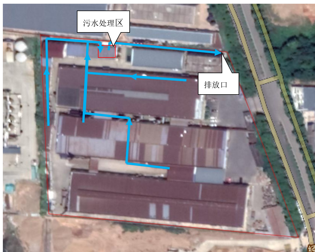
图 4.8-1 永诚场地污水管网图
