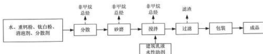
图 3-6 本项目水性涂料生产工艺流程及产污环节示意图
