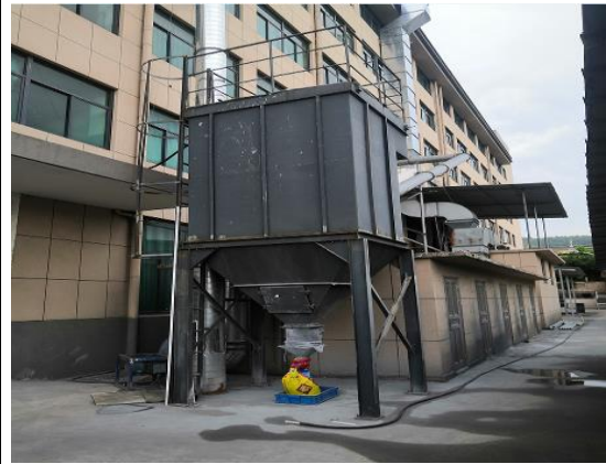
脉冲式布袋除尘器（喷金粉尘）
