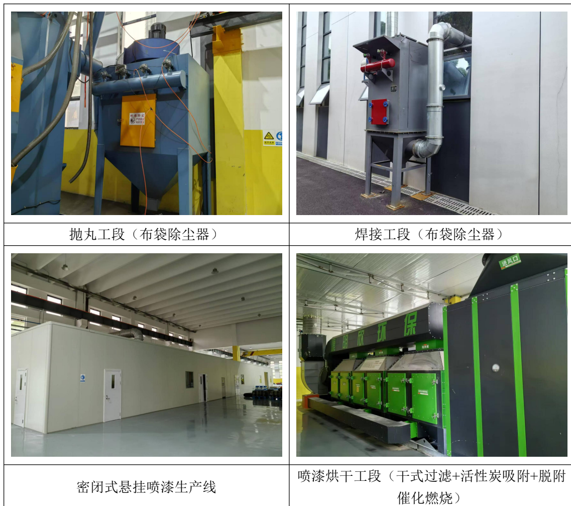
图 4-3 本项目废气处理工艺流程
