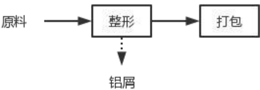
图 3-10 本项目铝线生产工艺及产污流程图
