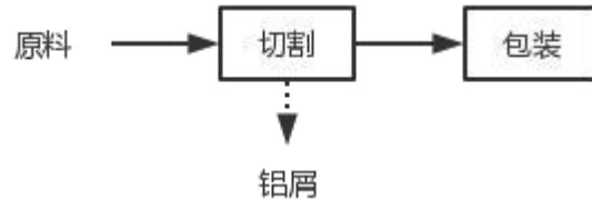
图 3-11 本项目铝粒、铝块生产工艺及产污流程图
